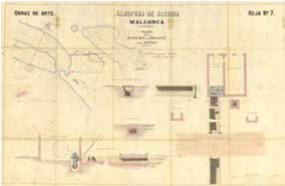
Sig-7815. Albufera de Alcudia (Mallorca). Plano de la Estación de Desagüe cerca de Alcudia. Realitzat per J.F. Bateman el 1866. Arxiu del Regne de Mallorca i Direcció General de Recursos Hídrics (CAIB).
